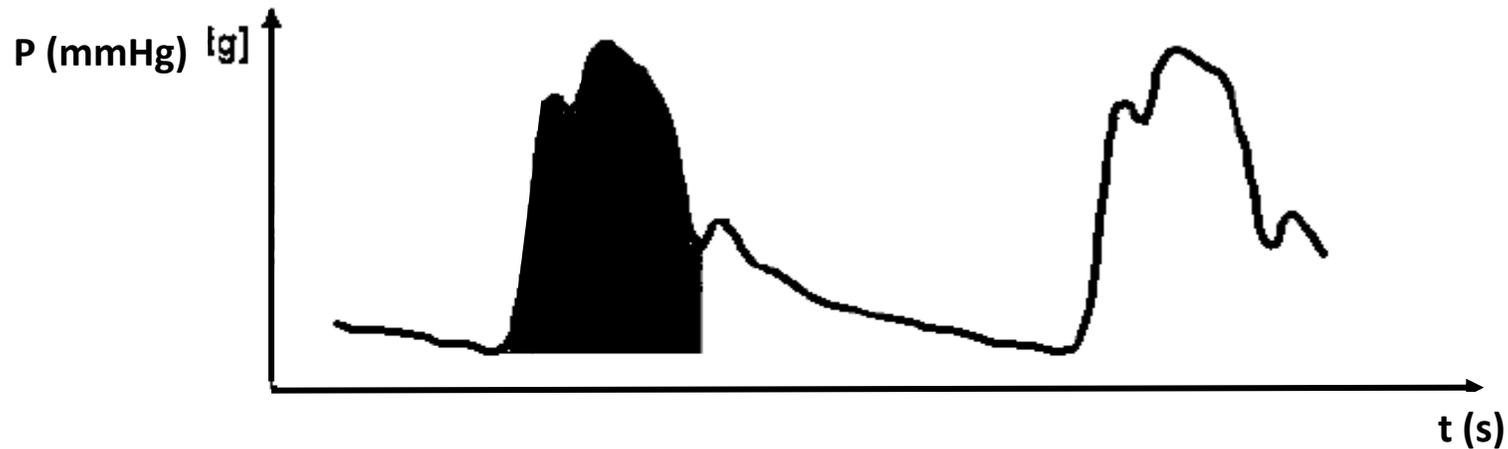
$$\text{PCCO} = \underbrace{\text{cal}} \cdot \text{HR} \cdot \underbrace{\int_{\text{systole}} (P(t)/\text{SVR} + C(p) \cdot dP/dt) dt}_{\text{Surface sous la courbe}}$$
